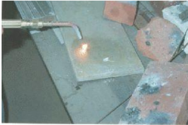
Fusion d'un petit morceau de brique
